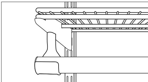
Вначале установите торцевые заглушки по краям штанги. Установите штангу для вешалок в подвеску сверху вниз до плотного прилегания.
